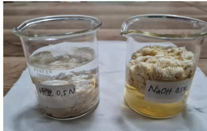
*Gambar 4.1. Proses Perendaman Kapuk Menggunakan HCL dan NaOH*
